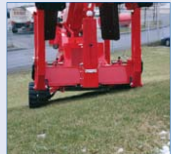
Fahrt auf unebenen Gelände mit dem höhen- und breitenverstellbarem Kettenfahrwerk jederzeit möglich
